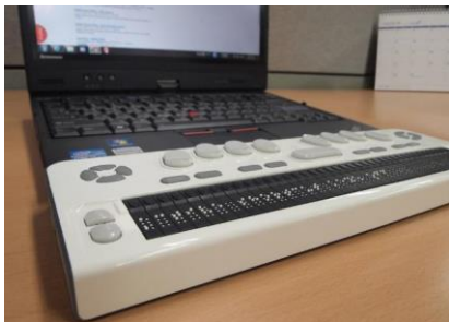
Figuur 6 Brailleleesregel gekoppeld aan een laptop (bron: http://www.hims-inc.com/product/braille-edge-40/ )
